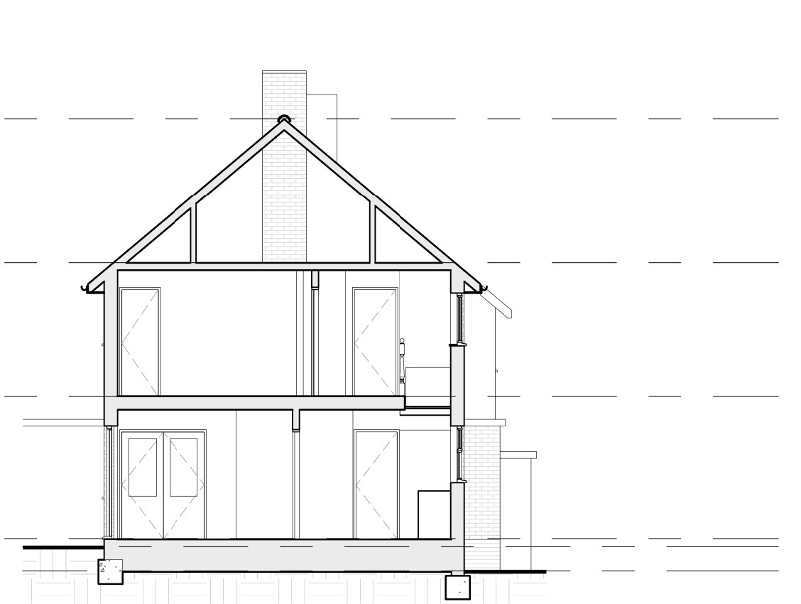
EXISTING SECTION A-A 1:100 @ A3
