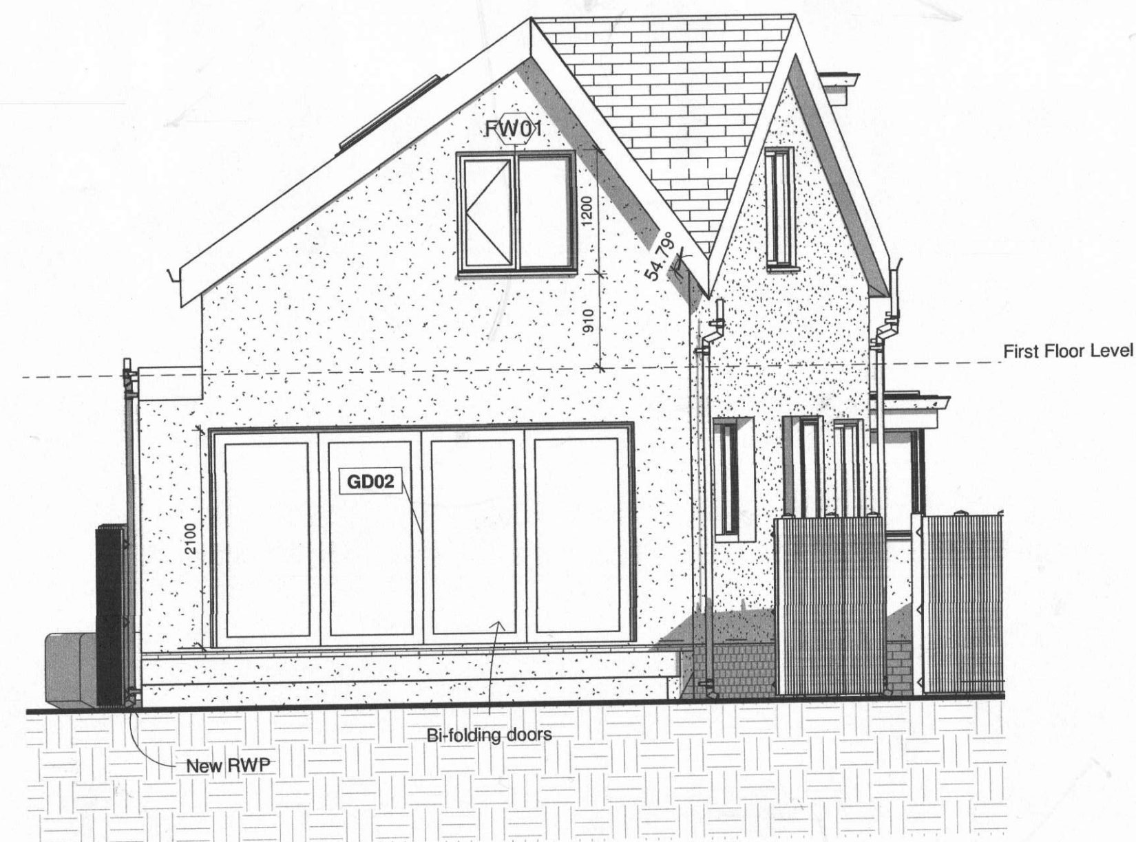
4 Side Elevation SE - Construction 1 : 50
